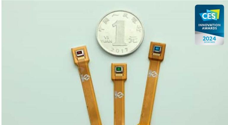
图二：由思坦国际半导体有限公司研发的「0.13" micro-LED 显示模组」具有超高像素密度（10,000ppi），为 AR/XR 产品显示单元提供高亮度、长寿命、高效率的优势，亦荣获「CES 2024 创新奖」（XR 技术及配件）。
